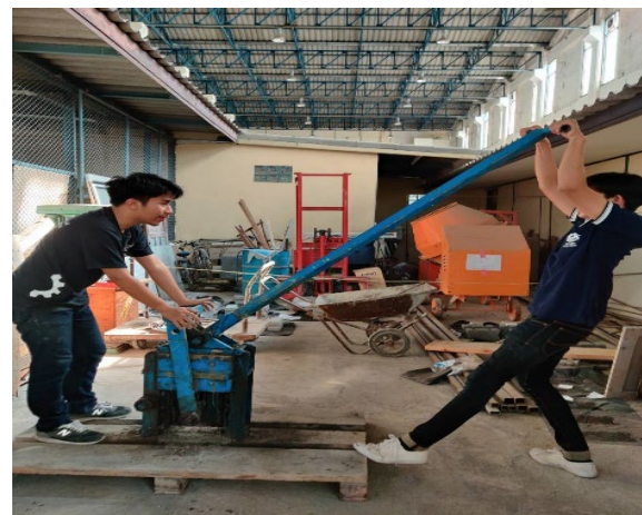
Fig. 3 CINVA-Ram block press machine.
