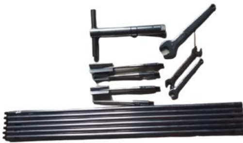
Fig. 4 Field vane apparatus
